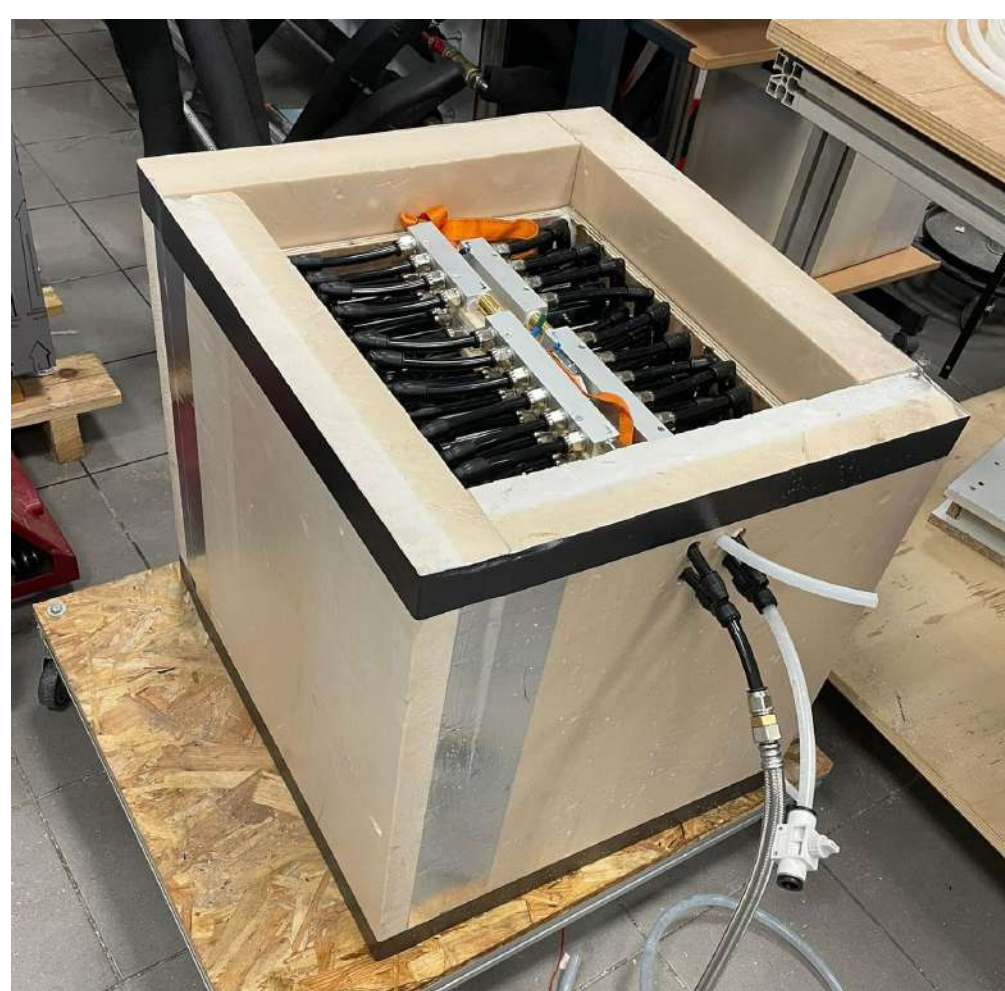
Prototype final de la batterie thermique à base de MCP
