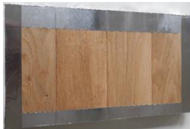
Figure 1 : Éprouvette d'essai avec chants protégés pour l'essai selon la norme NF EN ISO 16000-9 (parquet, scénario « Sol/Plafond »)
