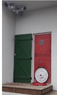
Figure 2 : Système blowing door permettant de générer une surpression dans les modules
