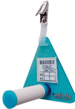
Figure 4 : Système Radiello® cartouche sur support [68]
