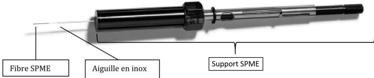
Figure 10 : Fibre SPME et son support
