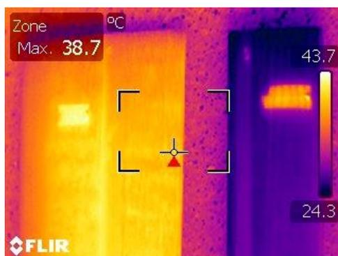
Figure 2.10 : exemple de mesure infrarouge pour les deux types de bardage.
