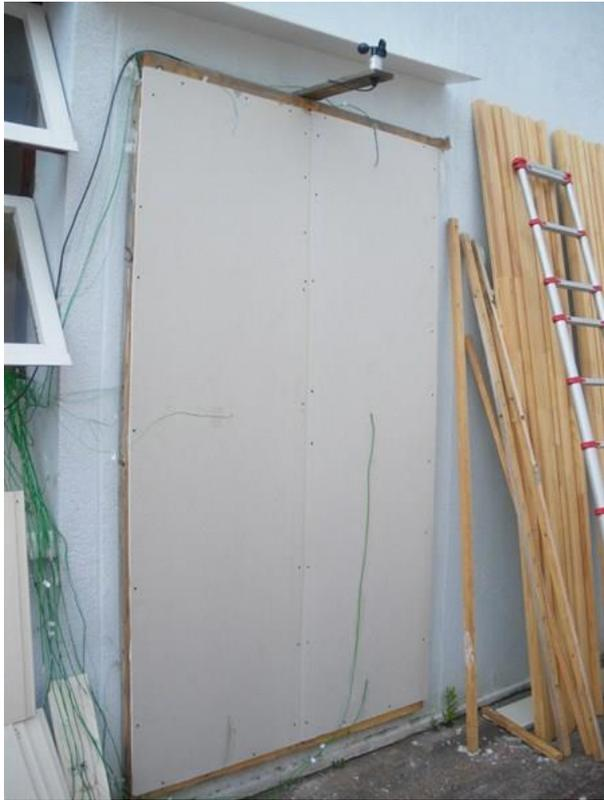
Figure 2.3 : Premier panneau de BA13 posé, thermocouples placés.
