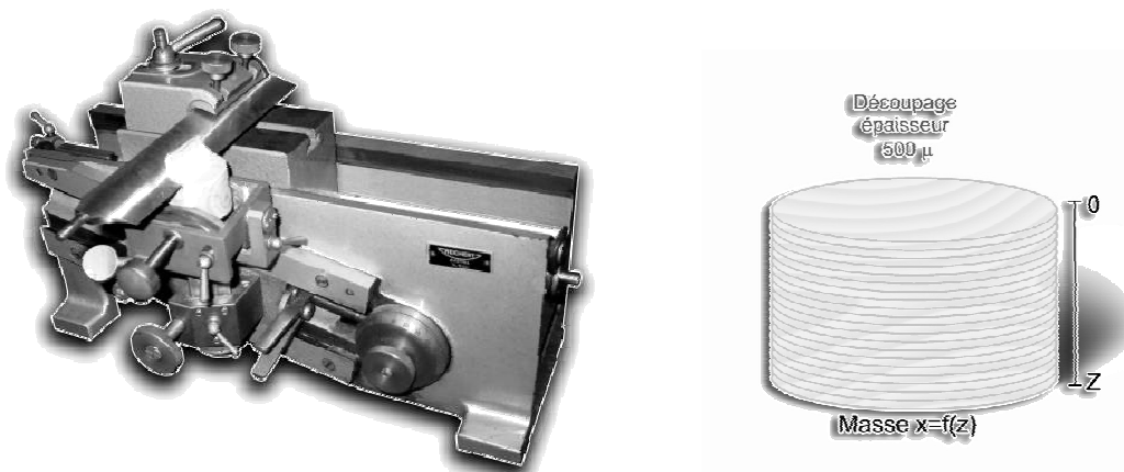
Figure 3.9 : découpages de l'échantillon en tranches fines horizontales (50 microns environ) à l'aide d'un microtome
