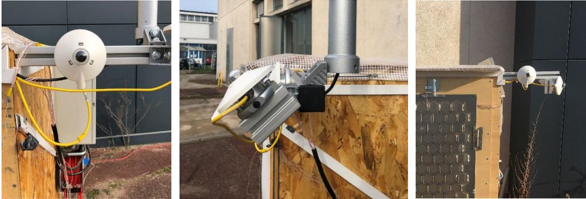
Figure 3.27 - Pyranomètre vertical et pyranomètre orientable installés sur la boîte test.
