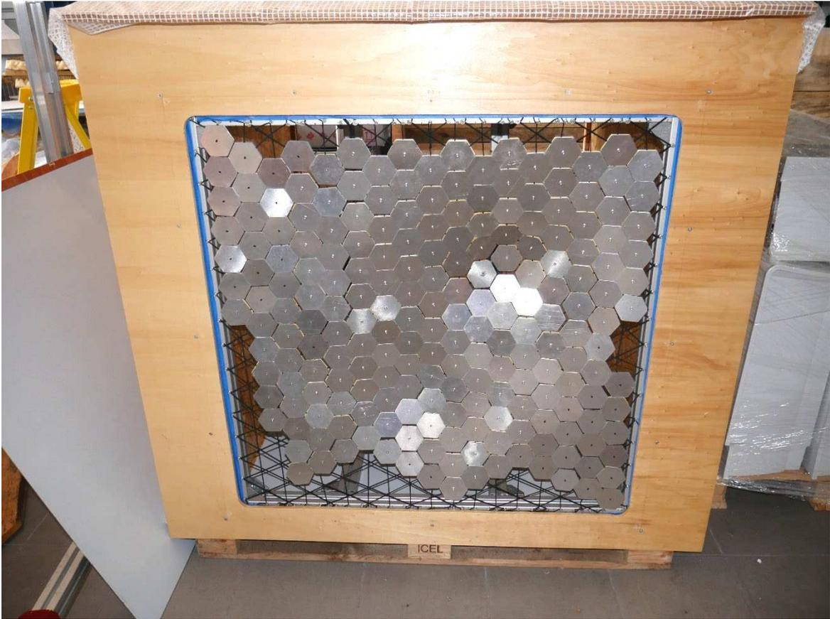
Figure 3.16 - Vue globale de la paroi déformable intégrée à une boîte bois.
