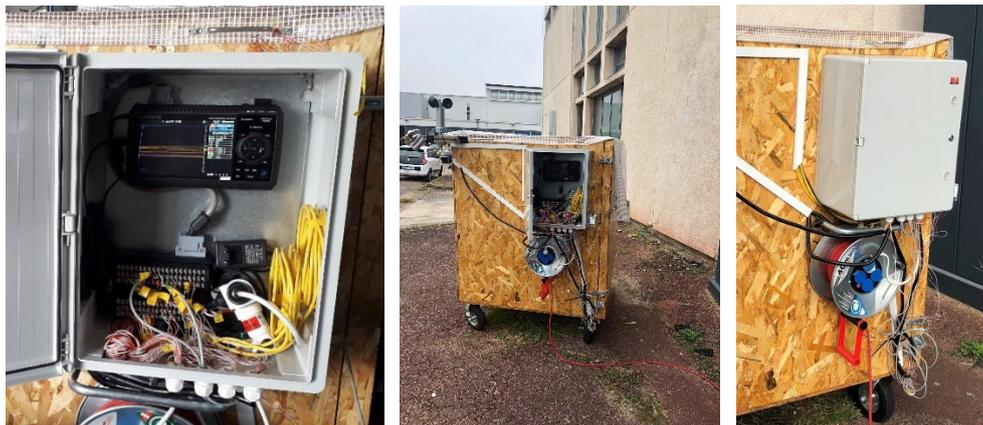
Figure 3.26 - Centrale d'acquisition et ses 40 voies dans le boîtier électrique et relié au câble d'alimentation fixé sur la boîte test.
