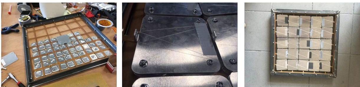
Figure C.5 - Montage des éléments de base et des clapets avec du fil transparent.
