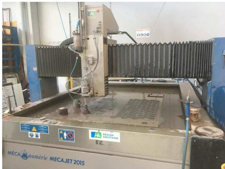
Figure 3.12 - Découpe au jet d'eau du cadre structurel.
