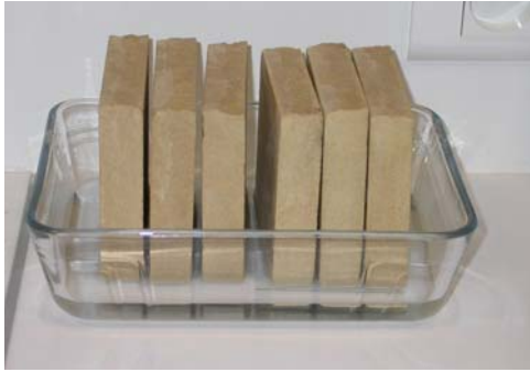
Figure II-2 : Photo des pierres en cours d'expérimentation pour le calcul de la capillarité.
